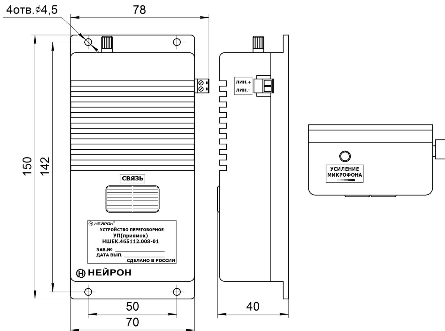
Рис.1 Внешний вид Устройство переговорное «УП(прямом) НШЕК.465112.008-01
